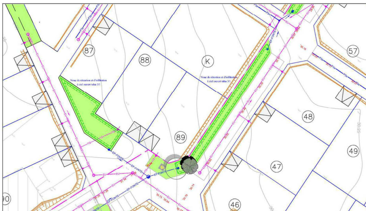
Ouvrages de rétention et d'infiltration - PA2-PA3
